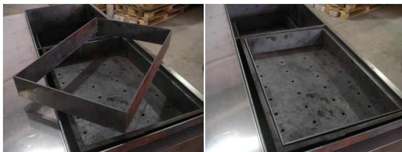
Защитный экран из стали 5 мм.
