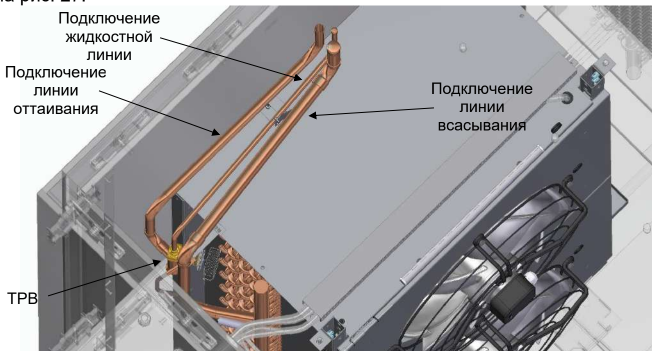
Рис. 27 Подключение выносного агрегата и конденсатора
